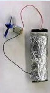
1回目は、**炭電池**についての実験を行いました。最初に**電流計**と**電圧計**の取り扱いを説明し、その後電池と電球を使って実際に電流と電圧の計測を行いました。食塩水に浸したキッチンペーパーにアルミホイルを巻くと、アルミホイルが溶け、電子が豆電球を通り、炭に入っている酸素が電子を受け取る原理で電流が流れます。また、**実験後のアルミホイルには穴があいており**、電気が通るといことは、食塩水がアルミホイルを溶かしているということだと確認しました。電流計と電圧計は大きな電気単位からコードをつなげないと故障してしまうことも確認をしました。2回目は、果物で電池を作りました。**イオン化傾向**の大きさの異なる2種類の金属を電解質溶液に浸すと電力が生じ、電池ができることを学習しました。
